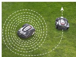
El Automower® detecta si entra en un área irregular, y cambia el corte a un patrón en espiral sistemático para nivelar el césped.
